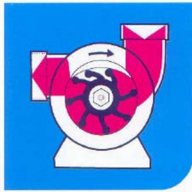
Funcionamiento de la bomba de impulsor flexible Trief.
